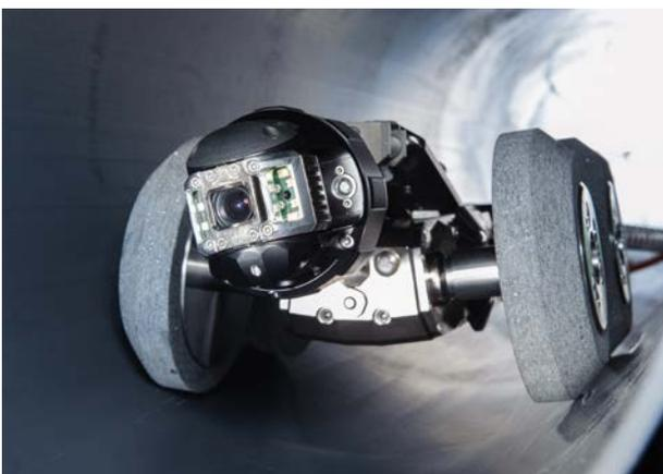
Abbildung 13: Kamerawagen (Quelle: VDRK)
